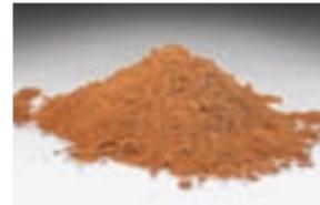
Der natürliche Ton wird hochfein zu Mehl vermahlen, nach exakter Rezeptur angefeuchtet und somit eine homogene Tonmasse erzeugt.
