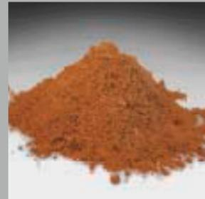
Reines, staubtrockenes Tonmehl bietet die Basis für nahezu feinkeramische Qualität der Ziegelkörper.
